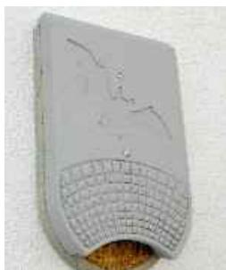
Abb. 1: Schwegler Fledermaus-Fassadenquartier 1FQ ist aus witterungsbeständigem und atmungsaktivem Holzbeton gefertigt. Das Fassadenquartier hat eine Größe von: Höhe 60 x Breite 35 x Tiefe 9 cm und ist als Spaltenquartier geeignet. Die Befestigung erfolgt mit vier Schrauben. (Quelle: SCHWEGLER Vogel- und Naturschutzprodukte GmbH)
